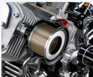
Filtro de aspiración: 10 µm
