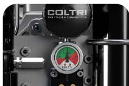
Pompa dell'olio con filtro e manometro
