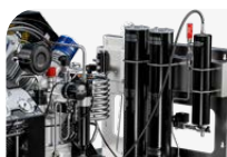
Sistema di purificazione su struttura "stand-alone"
