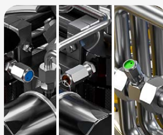
Soupapes de sécurité après chaque étape de compression
