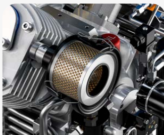
Filtre d'aspiration : 10 µm
