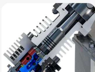
Deuxième, troisième et quatrième étages avec pistons poussoirs pour éliminer les forces latérales sur les pistons
