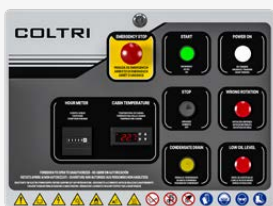
Control del compresor y sistema automático de drenaje de condensados
