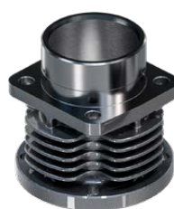
Cilindri in alluminio pressofuso ad elevata dispersione termica con rivestimento della canna in nicasil
