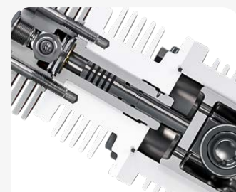
Troisième étage en acier trempé avec 5 segments de piston en fonte spéciale
