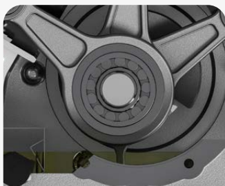
Lubrification par éclaboussures avec un axe de bielle immergé dans l'huile
