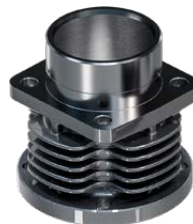
Cilindri in alluminio pressofuso ad elevata dispersione termica con rivestimento della canna in nicasil
