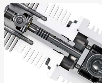
Terzo stadio in acciaio temperato con 5 segmenti in ghisa speciale
