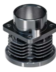
Cilindri in alluminio pressofuso ad elevata dispersione termica con rivestimento della canna in nicalon
